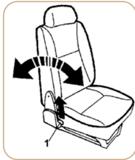
۱. اهرم تنظیم زاویه پشتی صندلی
