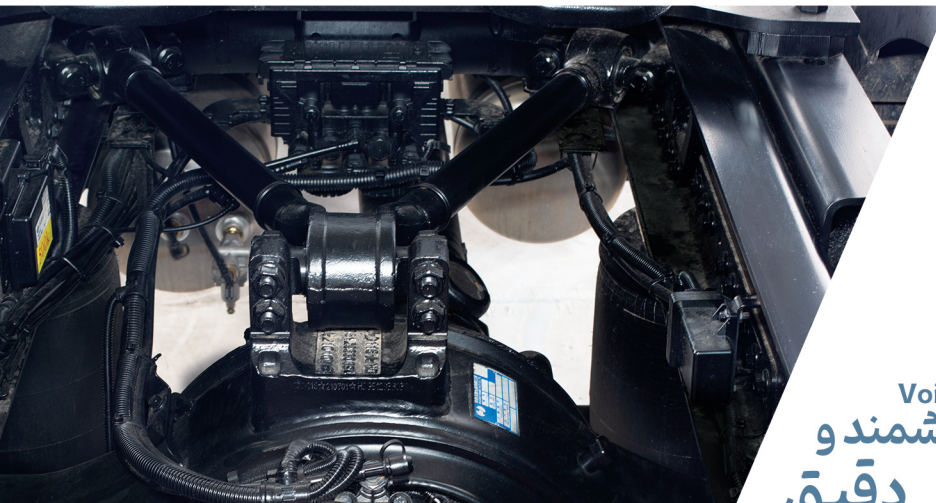
مجهز به بازوی نگهدارنده دیفرانسیل
